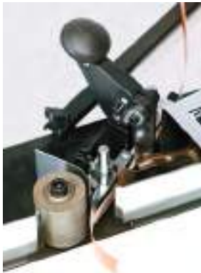
Doble guía de la banda y cizalla para el corte de borde.
